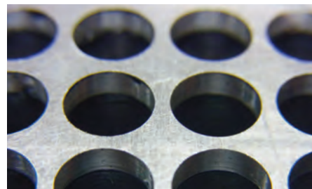
アルミ裏面(CFRP+アルミ同時穿孔) S=2660rpm F=37mm
