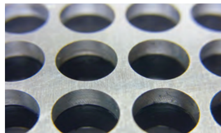
アルミ裏面(CFRTP+アルミ同時穿孔) S=2660rpm F=37mm
